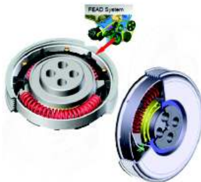
Litens扭矩调节器通过调节系统惯量的弹簧刚度来控制系统谐振频率
