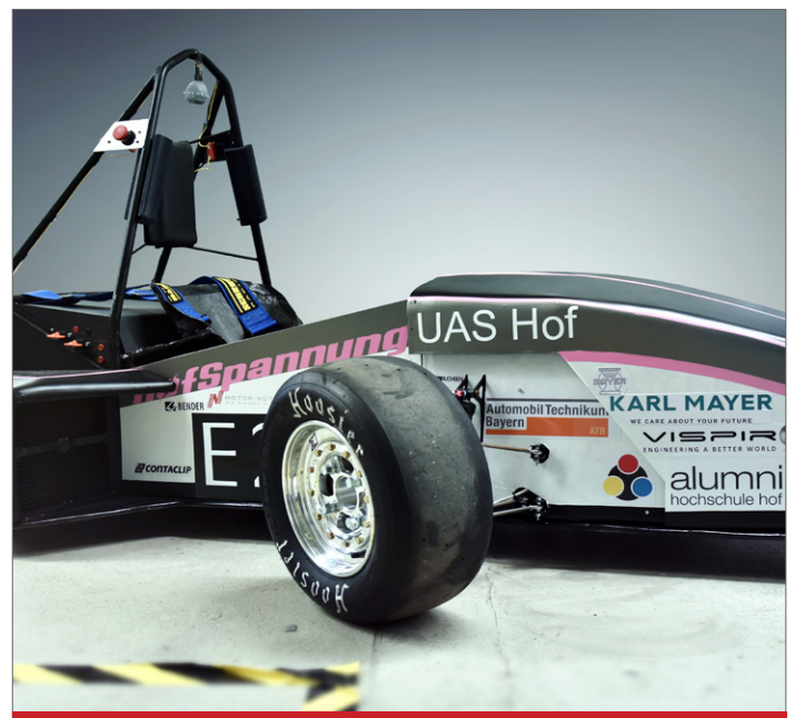
Bonnie: Die vierte Generation der Elektro-Boliden aus Hof realisiert 30 Prozent Gewichtsersparnis und beschleunigt in 3,5 Sekunden auf 100 Stundenkilometer
