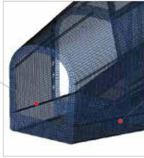
工程师对复杂表面的小平面去特征化（生成网格时会弯曲）
